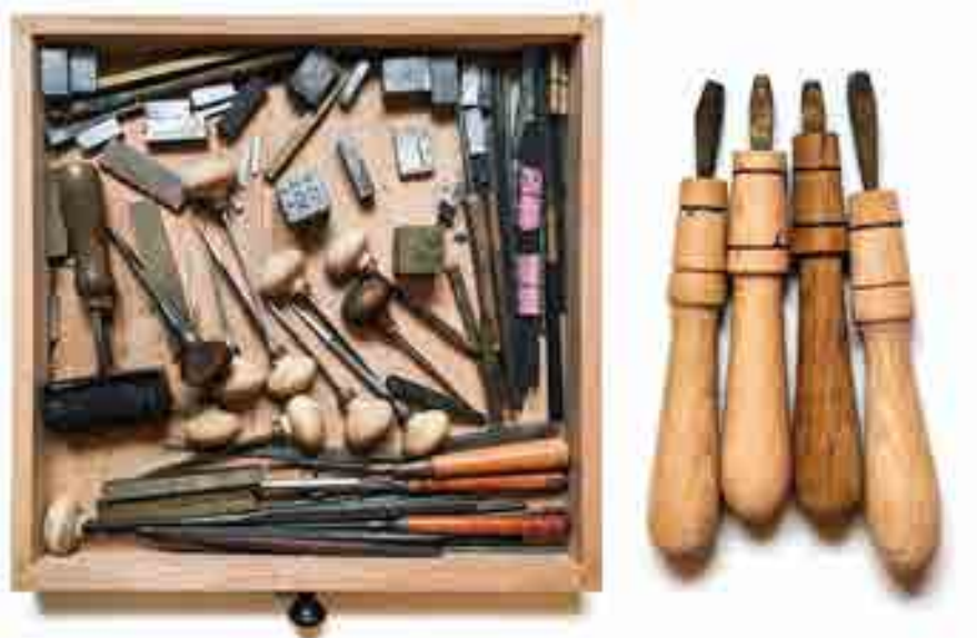
Abb. 2: Links: Das Werkzeug mit dem Gudrun Zapf-von Hesse 1946 die Messingstempel anfertigte, hat sie bis heute aufgehoben (fotografiert vom Autoren in der Werkstatt von GZvH). Rechts: Mit Holzgriffen versehen, dienten die Buchstaben der Buchbinderin über Jahrzehnte als Werkzeuge zum Vergolden von Schriftzügen auf Bucheinbänden (fotografiert von Norman Posselt).
